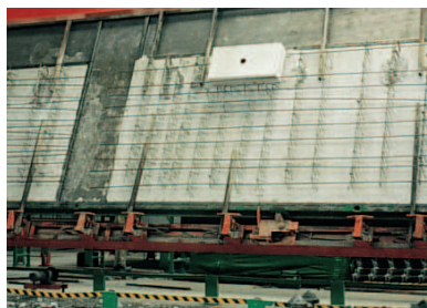
A külső szerelési lap a fal megfordításakor, illetve szállításnál is biztonságosan megmarad a keretben
